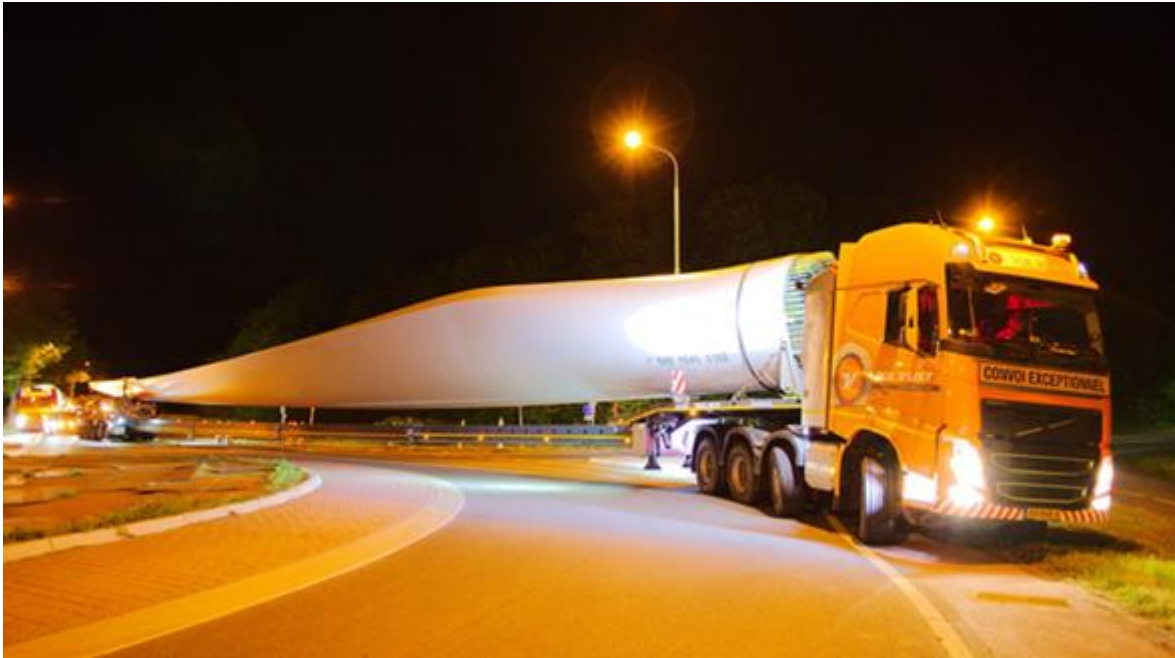
Figuur 3: aanvoer van één wiek van een windturbine.
